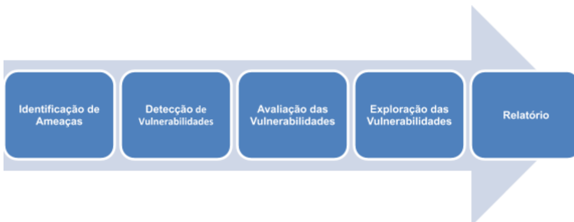
Figura 3. Ilustração das etapas do processo de testes de intrusão.
